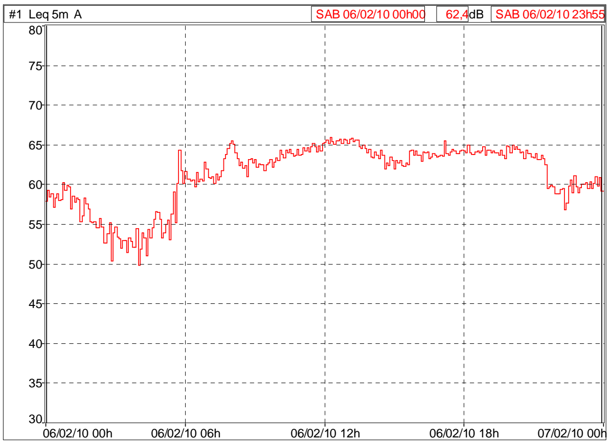
Figura 12: Edificio Via R. D'Andreotto 12 – profilo temporale del livello equivalente LeqA (sabato 6 febbraio 2010)
