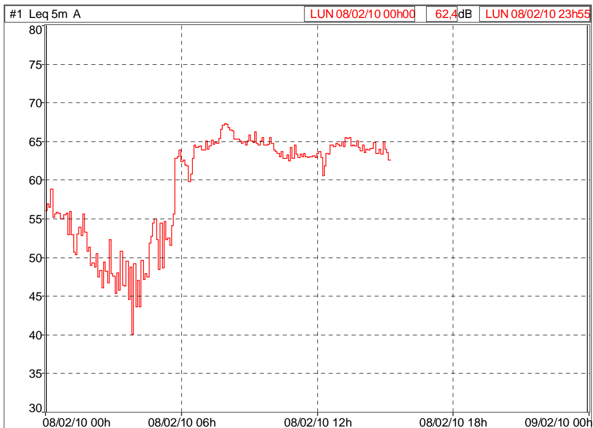
Figura 14: Edificio Via R. D'Andreotto 12 – profilo temporale del livello equivalente LeqA (lunedì 8 febbraio 2010)
