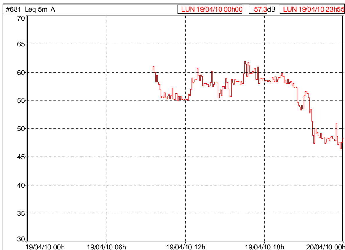
Figura 17: Edificio Via Morgagni 1 – profilo temporale del livello equivalente LeqA (dB) (lunedì 19 aprile 2010)
