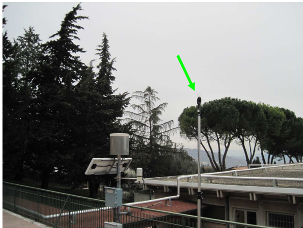
Fotografia 8: Stazione di monitoraggio acustico installata sul terrazzo della Scuola dell'infanzia di Chiugiana.
