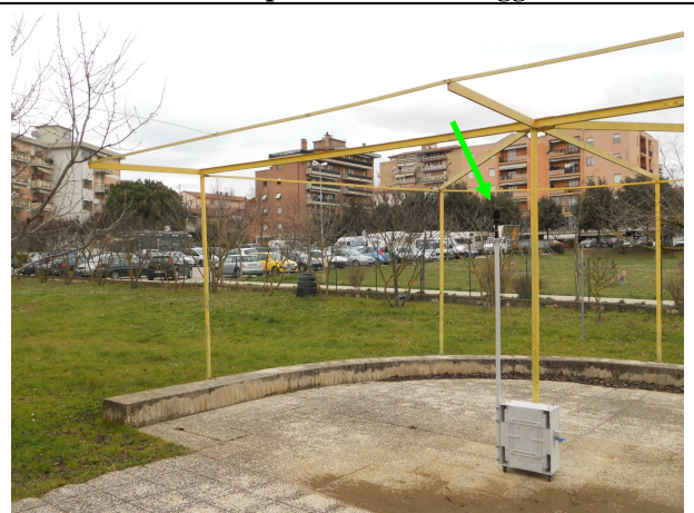
Fotografia 8: Stazione di monitoraggio acustico installata sul punto di monitoraggio P2.
