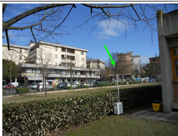
Fotografia 5: Stazione di monitoraggio acustico installata sul punto di monitoraggio P1.
