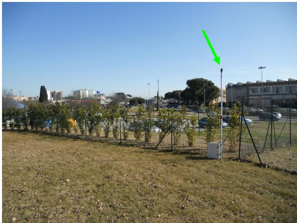
**Fotografia 4: Stazione di monitoraggio acustico installata sul punto di monitoraggio P1.**
