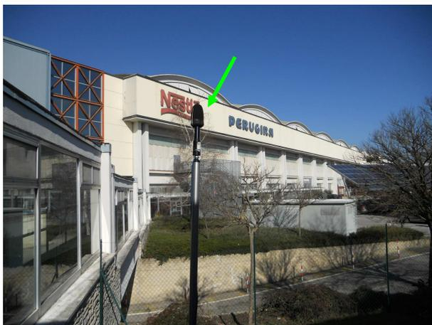
**Fotografia 6: Stazione di monitoraggio acustico installata sul punto di monitoraggio P3.**
