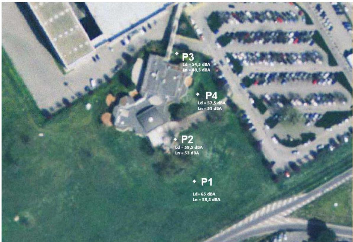
**Fotografia 3: Vista aerea del luogo dove sono state installate le postazioni fonometriche per il monitoraggio acustico esterno.**
