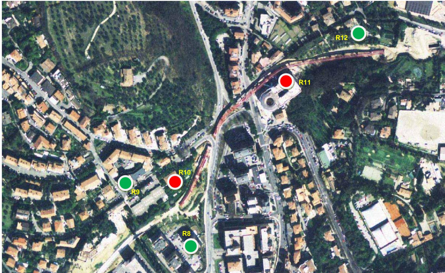
Figura 4: evidenziazione delle criticità circa i livelli di rumore misurati nei punti di misura R8 – R12. In verde sono contrassegnati i punti in cui è rispettato il limite di 60 dBA; in giallo i punti in cui il livello di rumore è appena inferiore al limite di 60 dBA; in rosso i punti in cui è superato il limite di 60 dBA.
