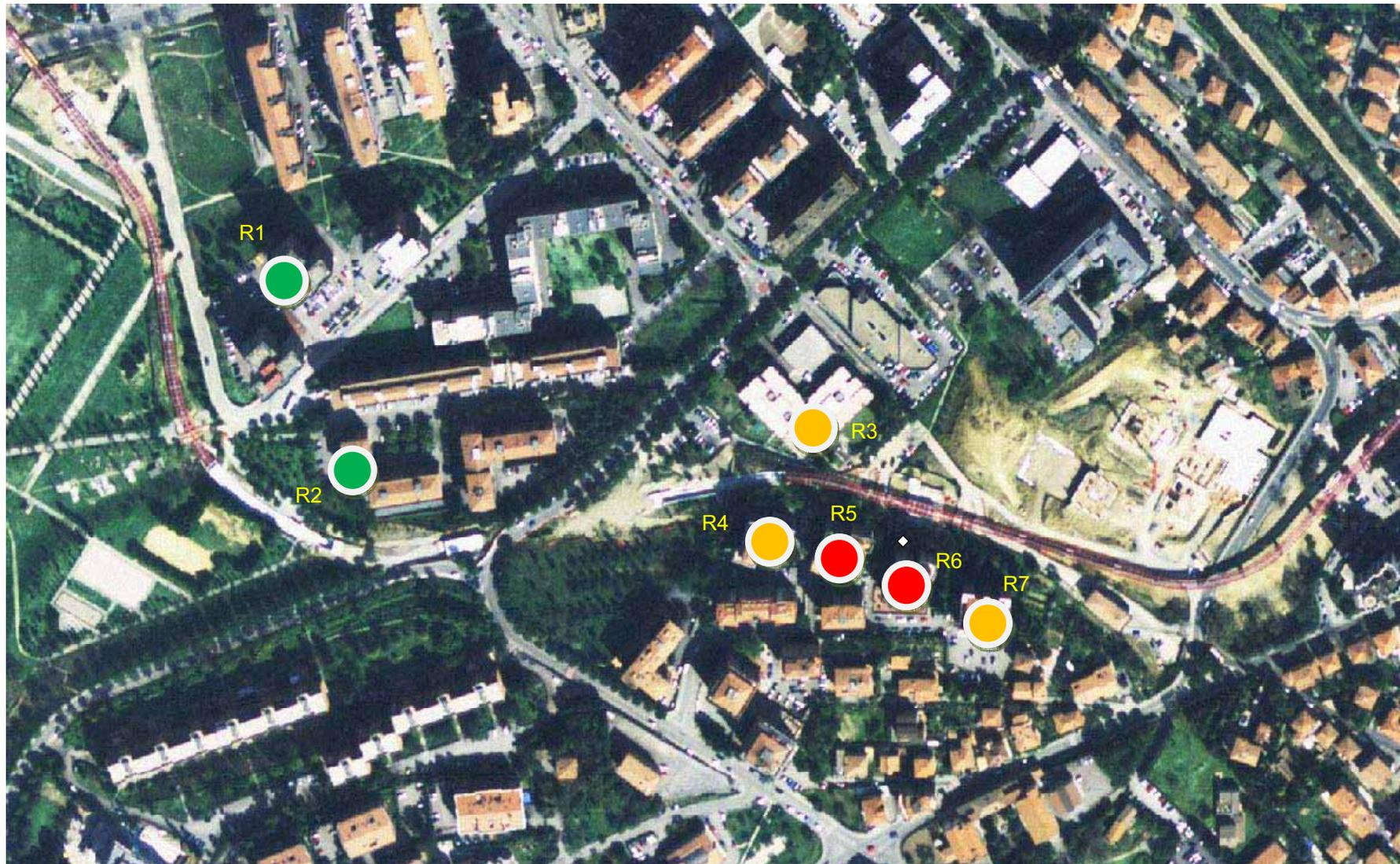
Figura 3: evidenziazione delle criticità circa i livelli di rumore misurati nei punti di misura R1 – R7. In verde sono contrassegnati i punti in cui è rispettato il limite di 60 dBA; in giallo i punti in cui il livello di rumore è appena inferiore al limite di 60 dBA; in rosso i punti in cui è superato il limite di 60 dBA.
