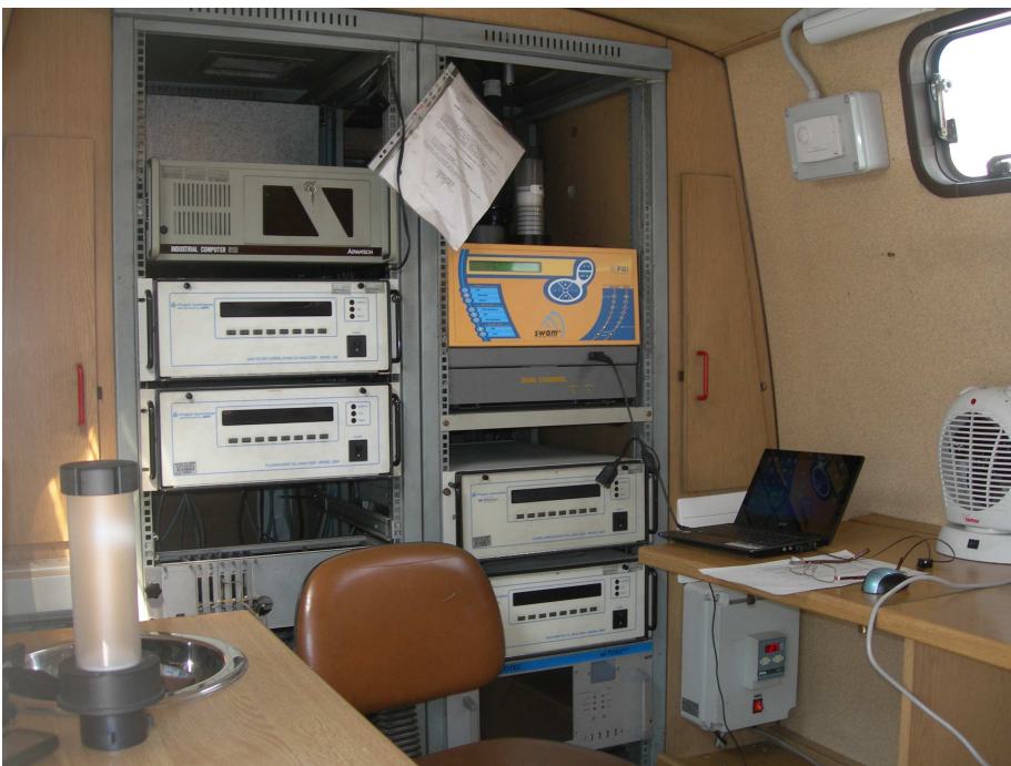
Fig. 3: Strumentazione analisi parametri inquinamento
