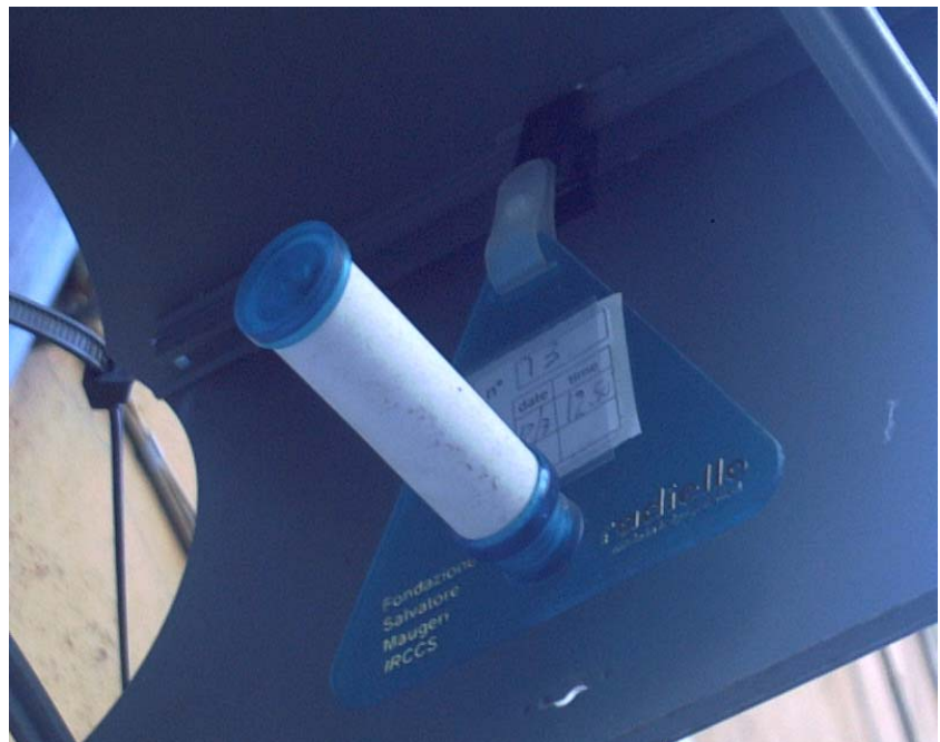
Fig.8 - Campionatori passivi Radiello R - particolare
