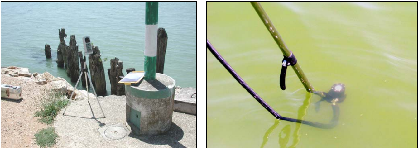
Fig. 1 A sinistra: fotometro solare EKO MS per la misura dell'aerosol atmosferico; a destra: misure radiometriche in acqua mediante spettroradiometro FieldSpec Fr Pro
