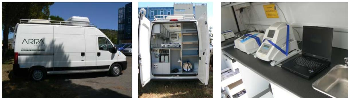
**Fig. 1.1** – Particolari del laboratorio mobile utilizzato dall'Agenzia per le determinazioni in campo.
