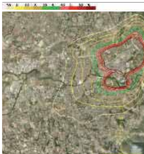
Figura 14 - Mappa dei massimi dei valori di HI orari relativi al polo chimico (espresso in tu/m^3 )
