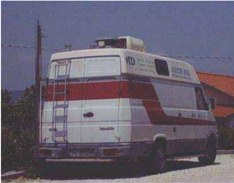
Fig 4 – Mezzo mobile rilevamento qualità aria
