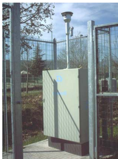
Fig 4 e 5 .Postazione per rilevamento PM10 (A e C)
