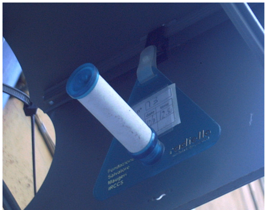
Fig.8 - Campionatori passivi Radiello R particolare
