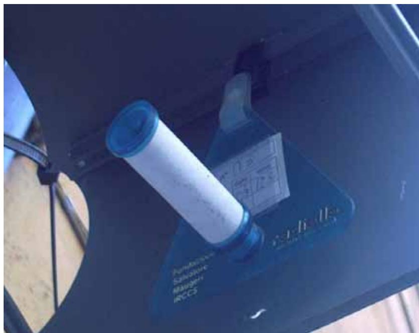
Fig.8 - Campionatori passivi Radiello<sup>R</sup> - particolare
