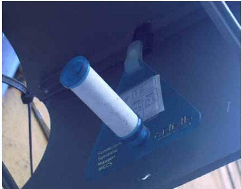
Fig.8 - Campionatori passivi Radiello<sup>R</sup> - particolare
