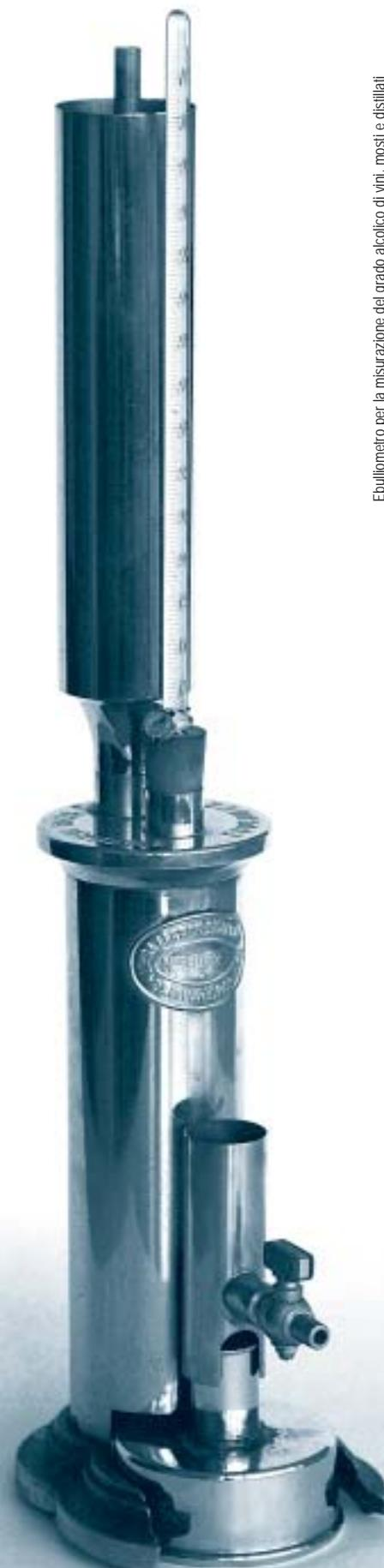
Ebullioscopio per la misurazione del grado alcolico di vini, mosti e distillati (Laboratorio Apex Umbria)
