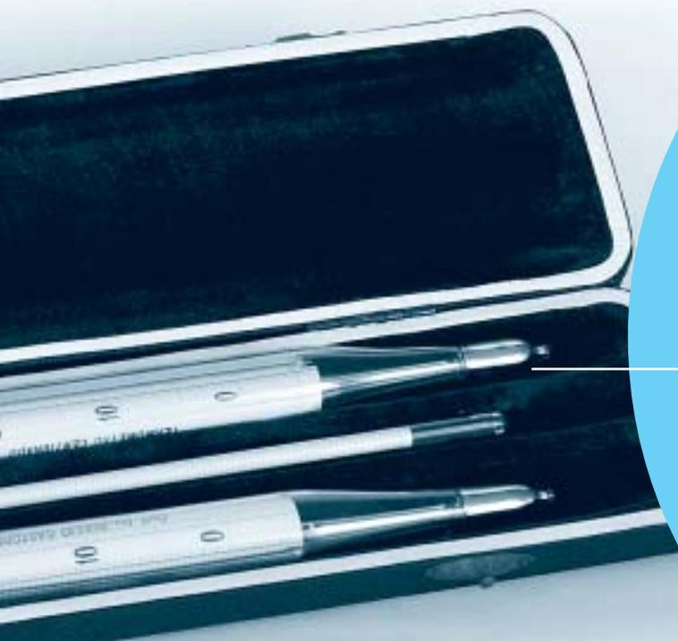
Densimetri per la misurazione della densità del latte
