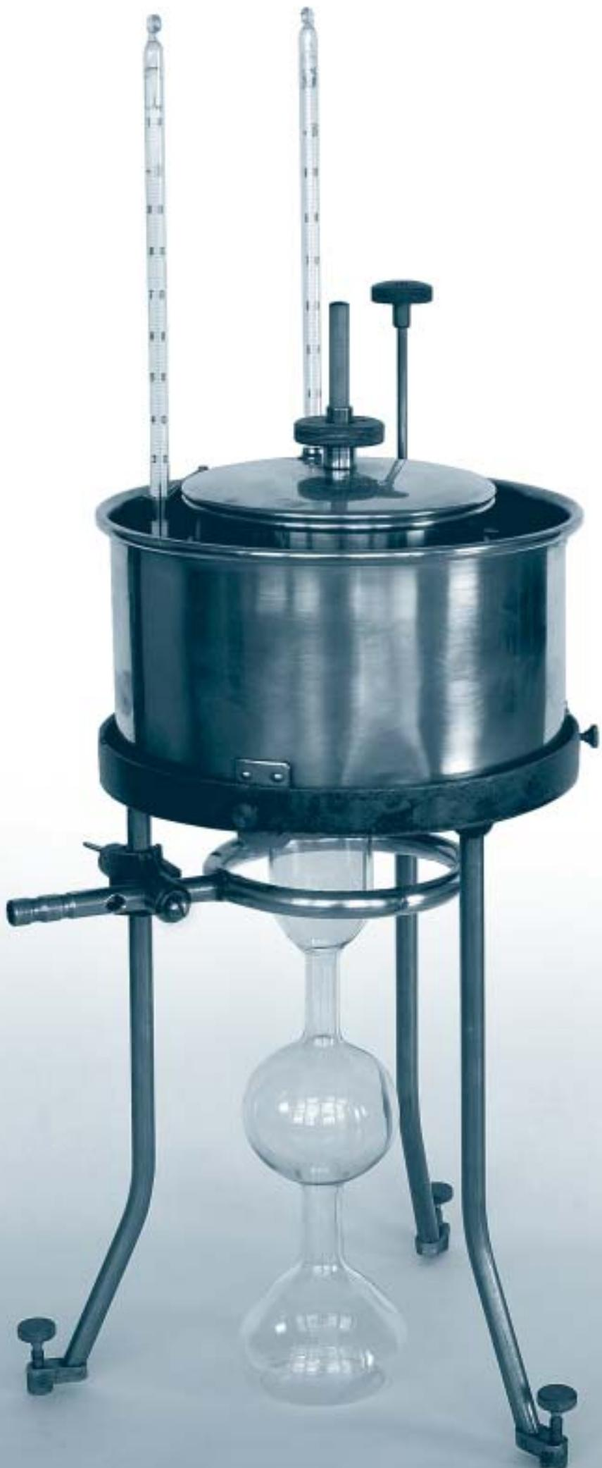
Viscosimetro per la misurazione del grado di viscosità di oli e derivati
