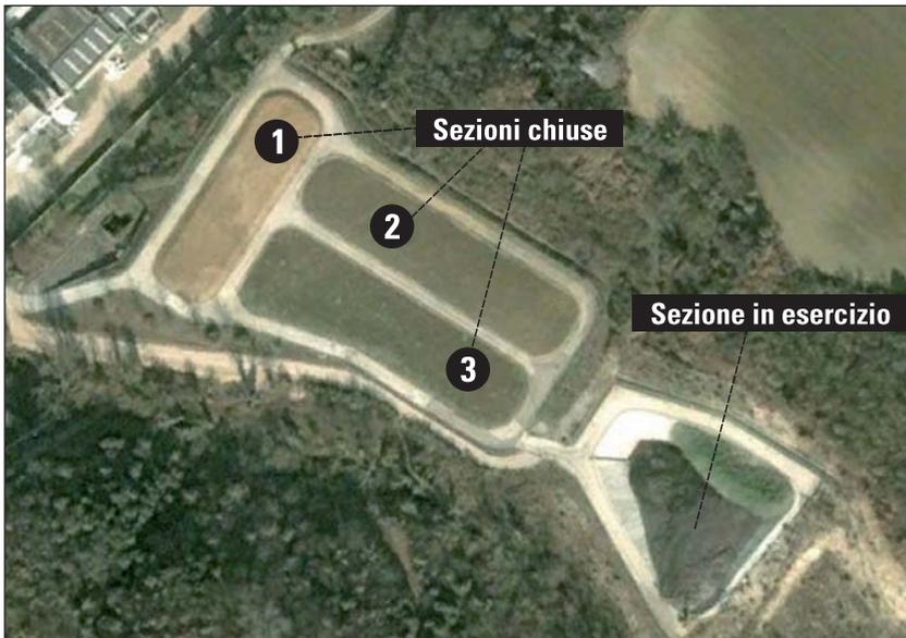
Figura 1 - Vista dall'alto della discarica; a sinistra le tre sezioni chiuse dove è stato realizzato il sistema di fitotrattamento, a destra in basso la sezione in esercizio
