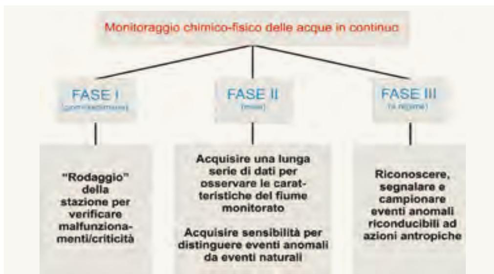
Figura 3.1 – Fasi relative all'applicazione di un punto di monitoraggio chimico-fisico continuo delle acque
