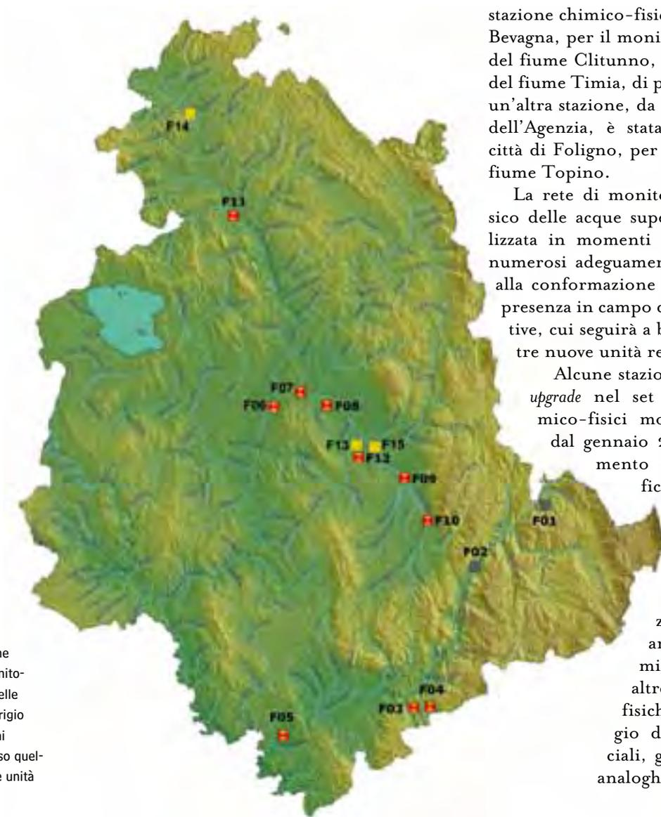
**Figura 1.1** – Ubicazione delle stazioni per il monitoraggio chimico-fisico delle acque superficiali. In grigio sono indicate le stazioni dismesse, in giallo/rosso quelle operative, in giallo le unità da attivare in futuro
