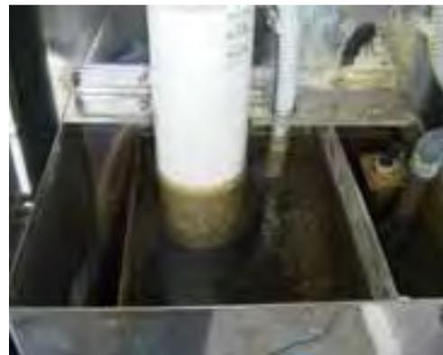
**Figura 11.3** - Cella di misura per l'alloggiamento della sonda multiparametrica
