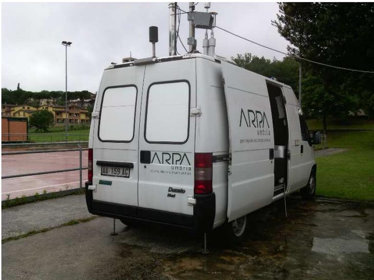
Fig. 4: Mezzo Mobile per il rilevamento della qualità dell'aria
