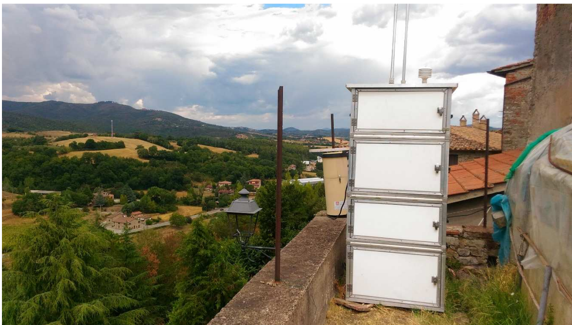
Fig.4: Campionatore di Particolato PM10 e deposimetro nella postazione di Piegaro
