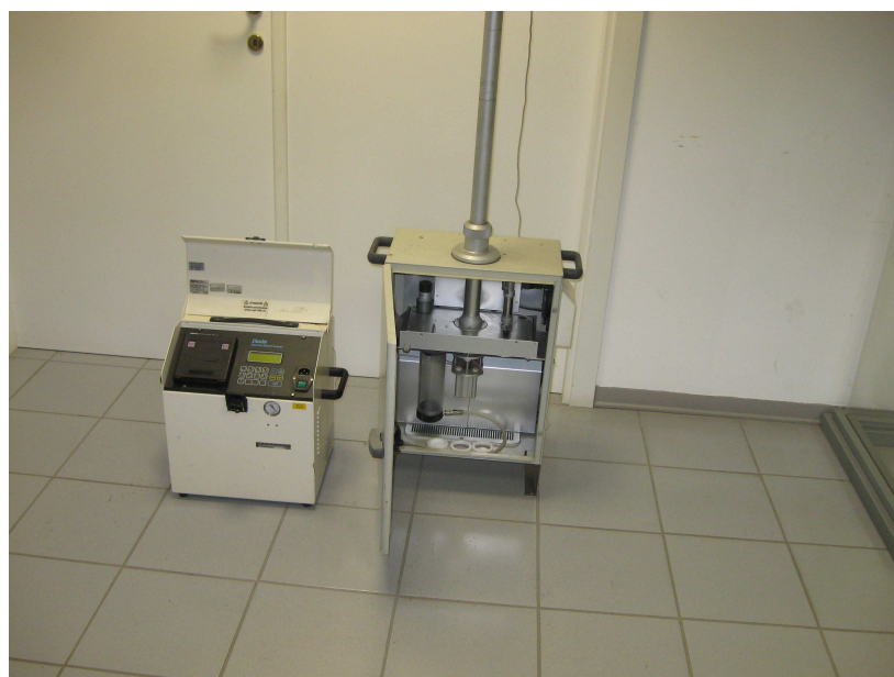
Fig. 3: Campionatore sequenziale Sentinel PM TCRTecora
