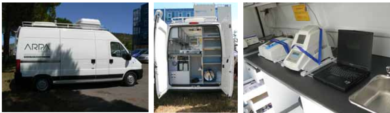
Fig. 1.1 – Particolari del laboratorio mobile utilizzato dall'Agenzia nel monitoraggio dei sedimenti fluviali e degli scarichi.
