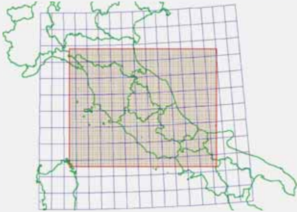
Figura 4 - Rappresentazione del dominio di calcolo della simulazione (griglia centrale a maglia più fitta delimitata dal bordo rosso) e del dominio delle condizioni al contorno (griglia più rada in blu). L'estensione del dominio di calcolo, nel sistema di riferimento piano WGS84-UTM32N, è da 542500,4547500 (angolo sud-ovest) a 1037500,4942500 (angolo nord-est).
