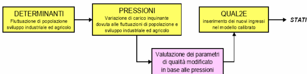
Fig. 77 - Esempio di schema di integrazione di QUAL2E nel contesto DPSIR
